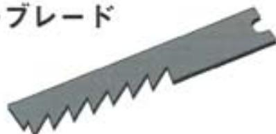
U型のへこみを浅くし、現行機種では使われてない取付穴を無くすことで、鋸刃の取付部の強度を向上させました。
